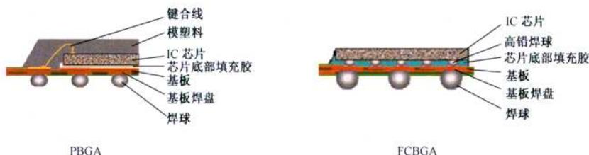
图 B.3 阵列类集成电路示意图
